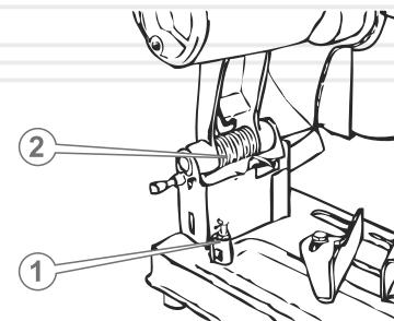
Щоб регулювати глибину різу, а також здійснити обмеження руху маятникового механізму (2), передбачений упор глибини різу (1), який розташований на металевій базі виробу (див. малюнок 3).
