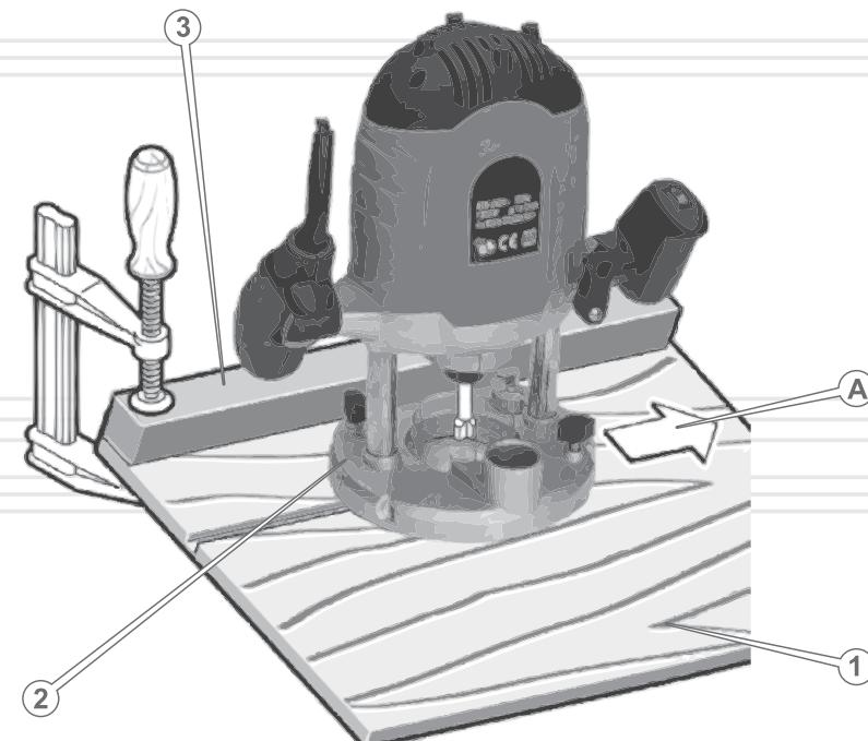
**Фрезерування з використанням паралельного упору
