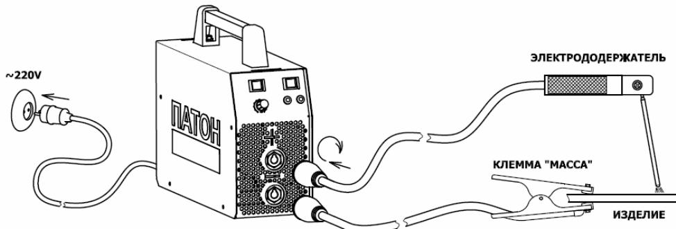
**Внимание!** После того как сетевой выключатель 6 переключен в положение «I», штучный электрод находится под напряжением. Не прикасайтесь электродом к токопроводящим или заземлённым предметам, таким как, например, корпус сварочного аппарата и т.д.
